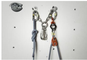
Fiksering i bolt – tilbageføring gennem pulley
